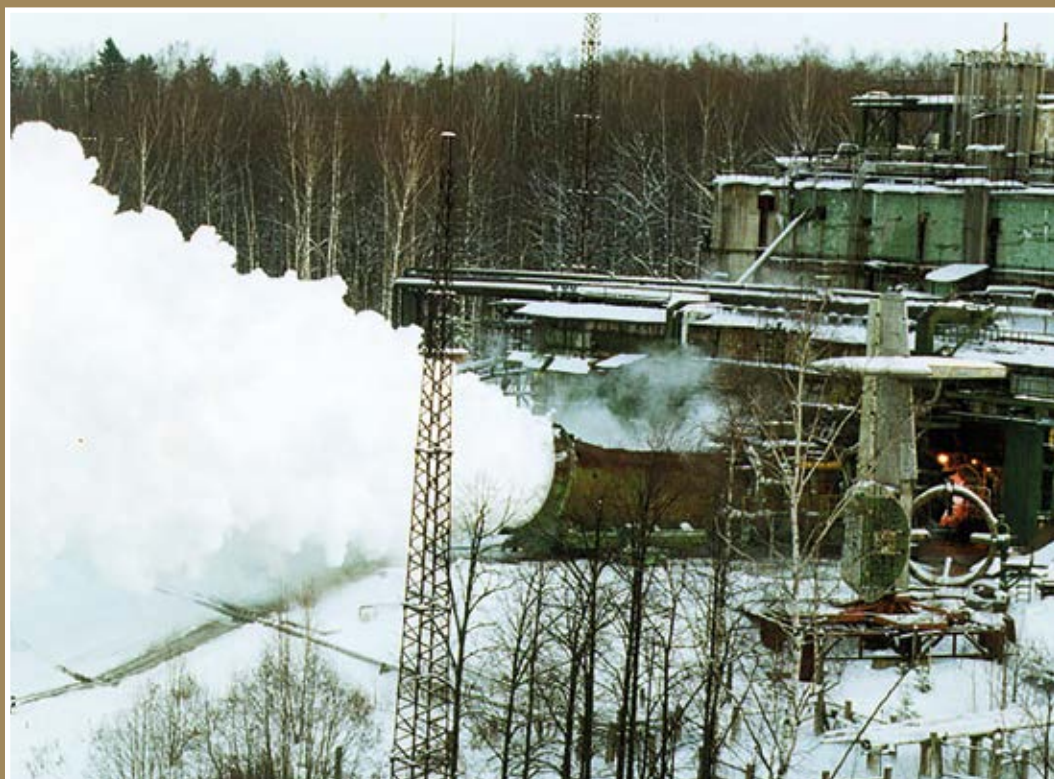
Испытания кислородно-водородного ЖРД на стенде В2
