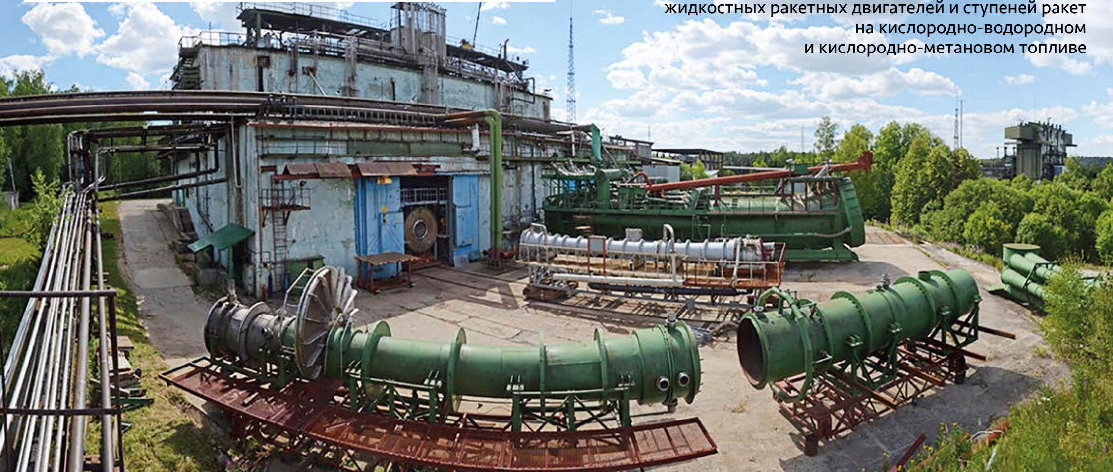
Кислородно-водородный разгонный блок 12КРБ после испытаний на стенде В3
